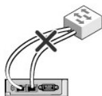
Figure 2-3. Mauvais câblage pour la connexion réseau CMC - 1 CMC
